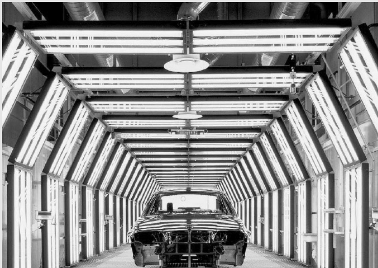
รูปที่ 3.7 ตัวอย่างการใช้แสงสว่างแบบมีทิศทางในการตรวจหาความสม่ำเสมอของชิ้นงาน
